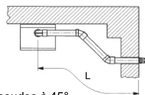
Veiller à ne pas diriger la sortie du conduit d'évacuation des produits de combustion vers une zone de vie.
