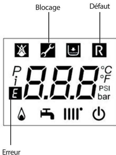
• En cas d'anomalie, le rétroéclairage de l'afficheur s'allume et affiche le code erreur correspondant.
